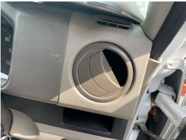
⑩運転席右側送風口に一部欠損有り
