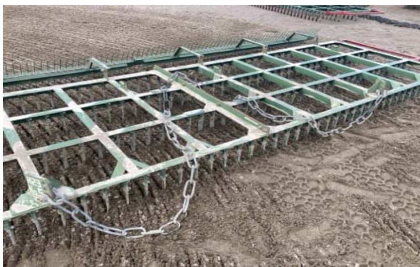
④3箇所牽引しているが、真ん中のチェーンのみでも牽引可能
