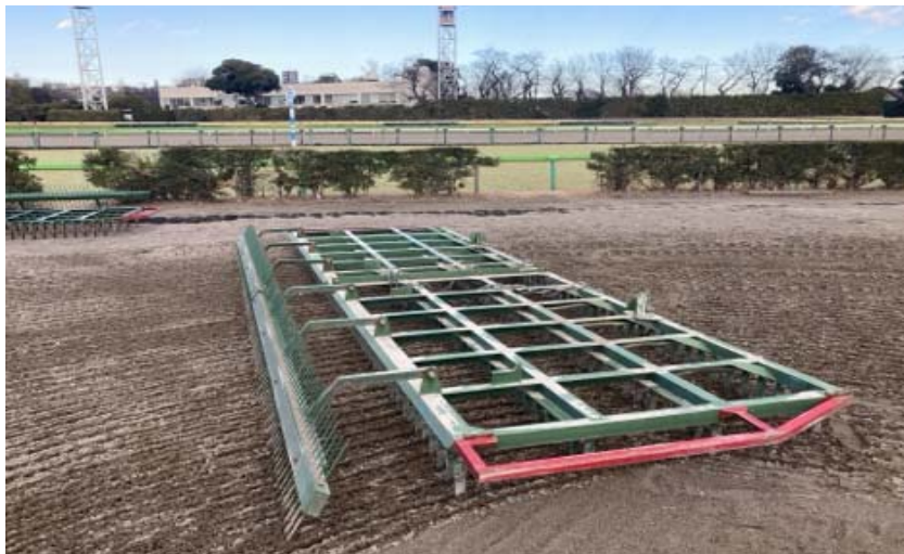
①全景 ※ユニモグで牽引可能
