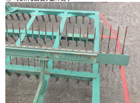
④均し爪も腐食、歪みあり
