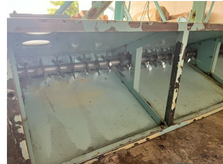
③回転軸は比較的良好的な状態。荷箱は腐食進む。
