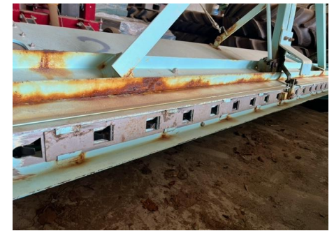
④散布用シャッター状況。変形によるひずみあり。
