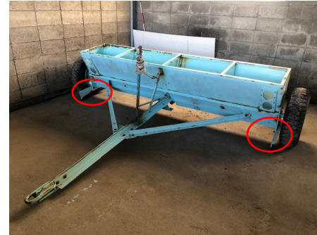
③回転軸は比較的良好的な状態。荷箱は腐食進む。
