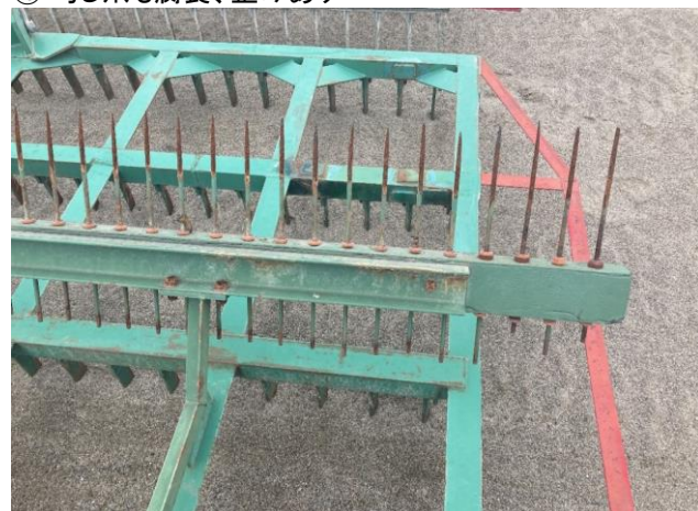
④均し爪も腐食、歪みあり
