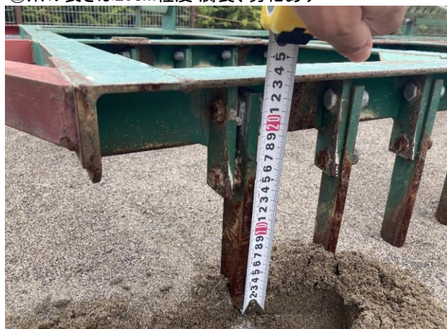
②爪の長さは20cm程度 腐食、劣化あり
