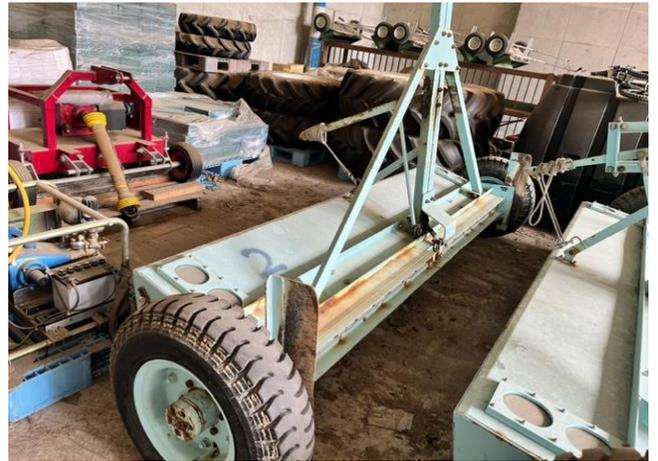
③回転軸は比較的良好な状態。荷箱は腐食進む。
