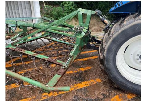
※3点リンク及び外部油圧系統2系統以上を有するトラクター(100馬力程度)が必要
