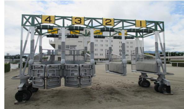
1. 製造より16年経過しており雨ざらしの状態では設置しているため、劣化の激しい状態となっています。
