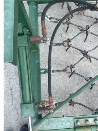
④3点リンクで牽引し油圧で開閉及び上下
