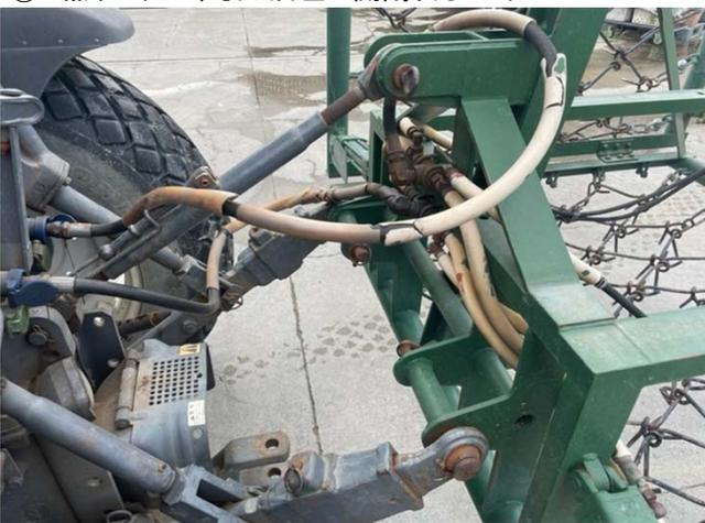
⑤ 3点リンクで牽引し油圧で開閉及び上下
