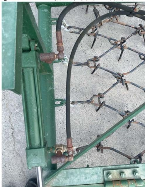
④ 3点リンクで牽引し油圧で開閉及び上下
