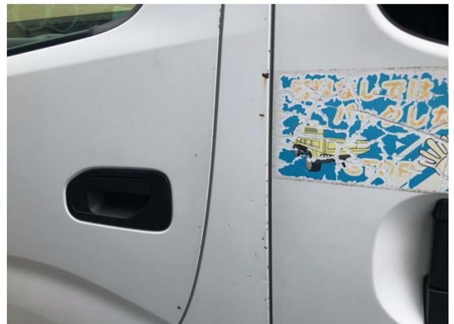
⑥参考写真 ※ボディ、各所の腐食あり
