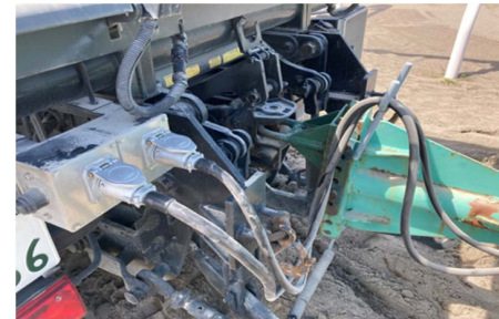
牽引は1ヶ所、油圧稼働用電源コード1本、油圧操作コード1本
