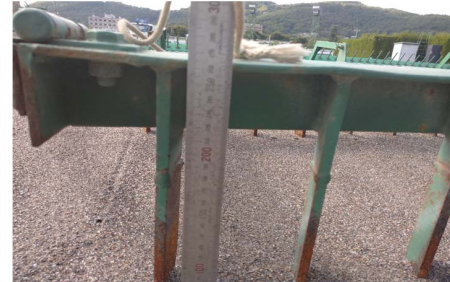
前爪長さ260mm程度 後爪長さ225mm程度
