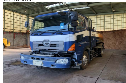
③フロント(前方圧力散水2基) ※左前方に擦過傷あり
