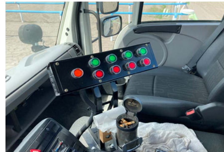
油圧操作盤と電源スイッチ
