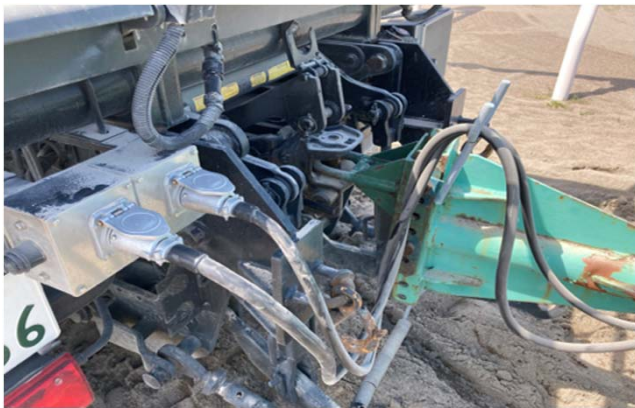
牽引は1ヵ所、油圧稼働用電源コード1本、油圧操作コード1本
