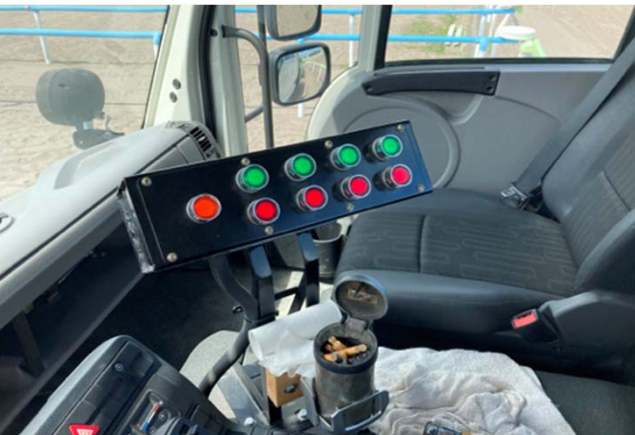
油圧操作盤と電源スイッチ (本体に付属してないので別途購入する必要がある) 油圧で稼働する部分は、本体移動用車輪の昇降、前方爪ハローの昇降、後方爪ハローの昇降
