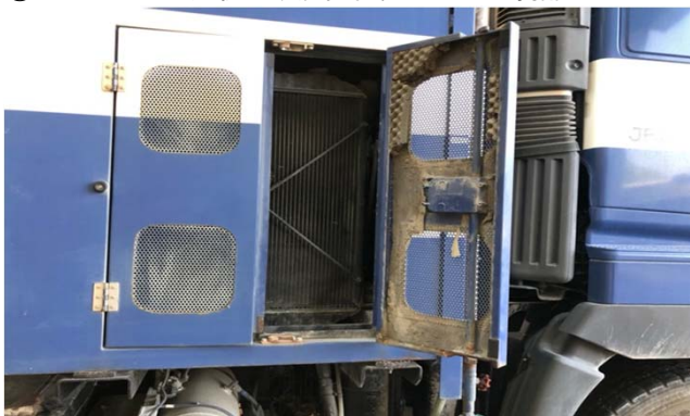
⑪サブエンジン点検窓、吸音材劣化による剥離
