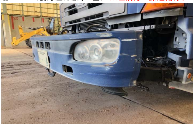
③フロント(前方圧力散水2基) ※左前方に擦過傷あり
