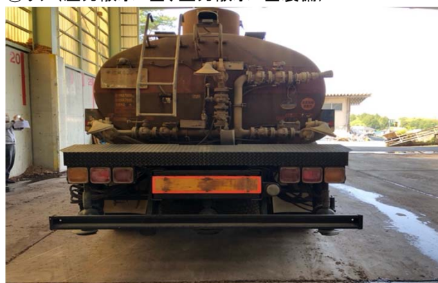
④リア(圧力散水3基、重力散水3基装備)
