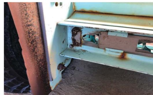
○泥除けプレート腐食激しい
