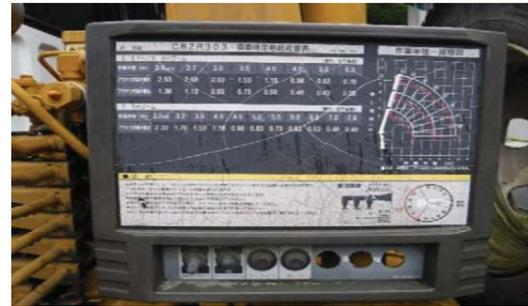
⑨吊上げ荷重2.9t 最大作業半径7.5m
