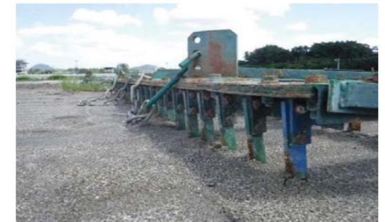
○フレーム前方 平爪取付部歪み有り
