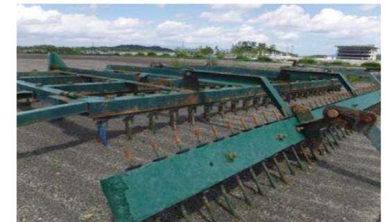
○フレーム後部 平爪及び均し爪は摩耗
