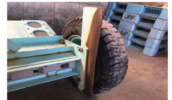
○泥除けプレート腐食激しい
