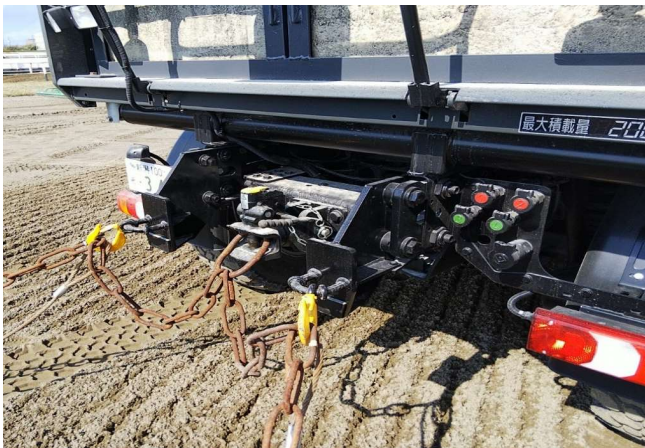
3箇所で牽引しているが、真ん中のチェーンのみでも牽引可能
