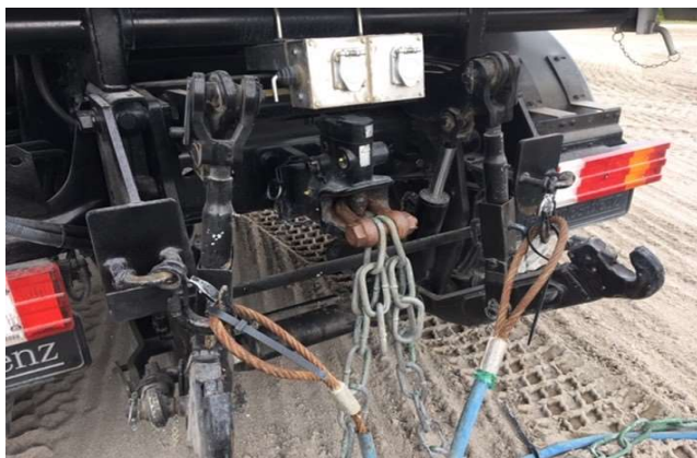
3箇所牽引しているが、真ん中のチェーンのみでも牽引可能
