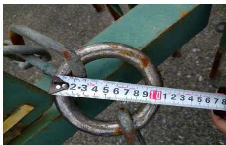
爪の長さは18cm程度(ボルト交換式)
