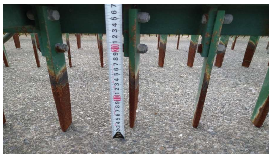
爪の長さは18cm程度(ボルト交換式)
