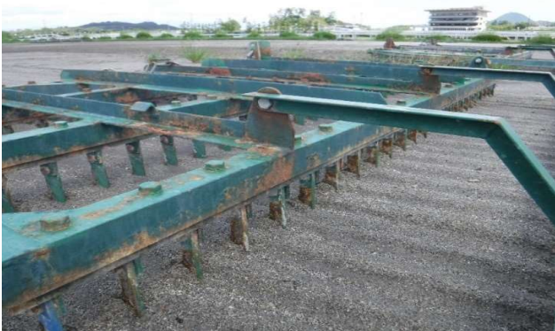
○フレーム後部 鉄部全体に腐食あり
