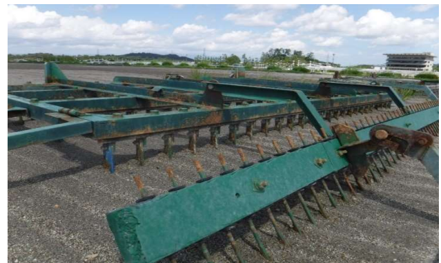
○フレーム後部 平爪及び均し爪は摩耗
