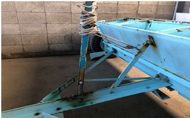
○散布シャッター開閉レバー やや動きが硬い
