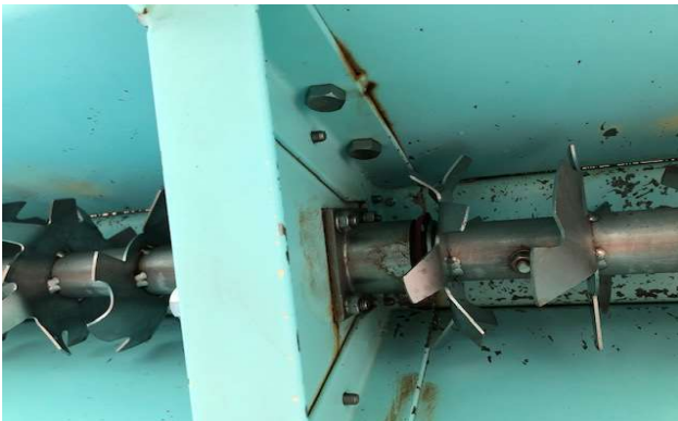
○攪拌軸状況 ベアリングの定期的な交換必要
