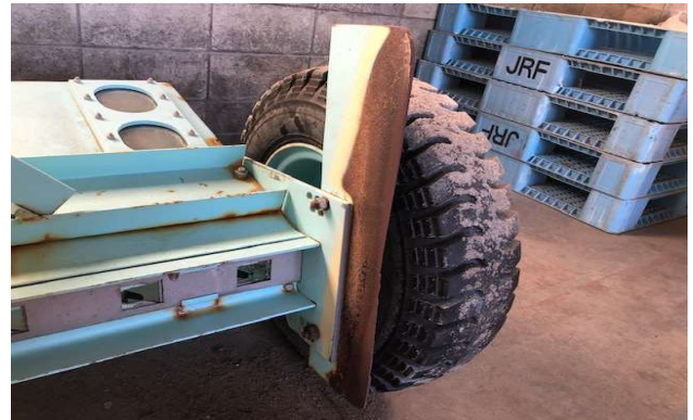
○泥除けプレート腐食激しい
