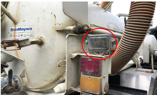
⑤テールランプ上の作業灯は故障しています
