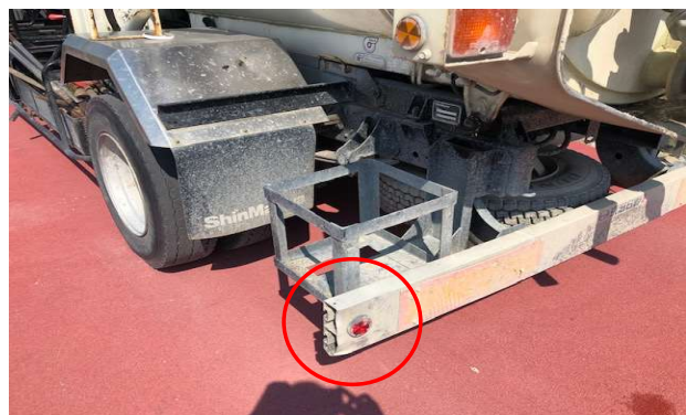
⑧バンパー端部金具、破損のため取り外しています。 ※スペアタイヤ付属
