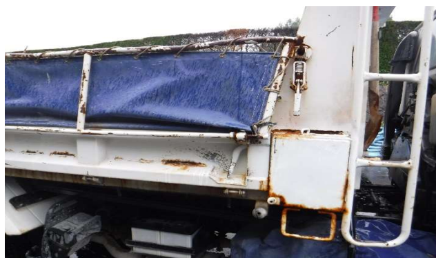
⑦荷台経年劣化により荷台腐食あり
