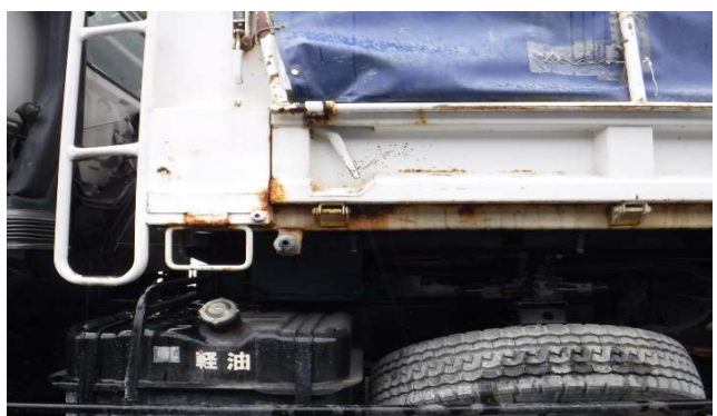
⑧荷台経年劣化により荷台腐食あり
