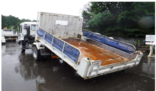
⑥外観(荷台) 経年劣化により荷台腐食あり
