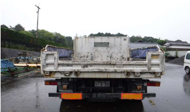
⑤外観(荷台) 経年劣化により荷台腐食あり
