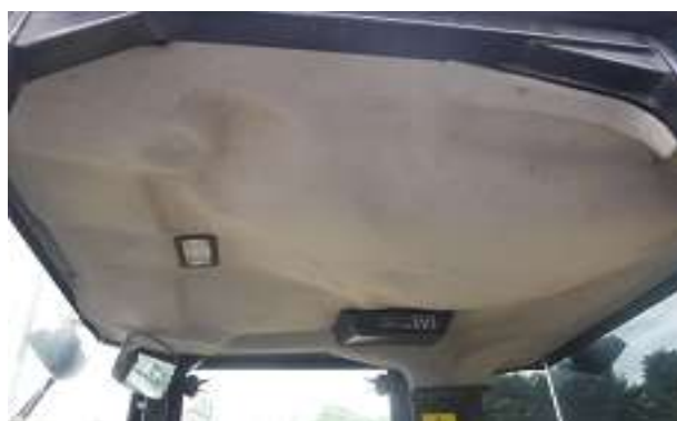
⑥社内状況 天井シート剥がれ
